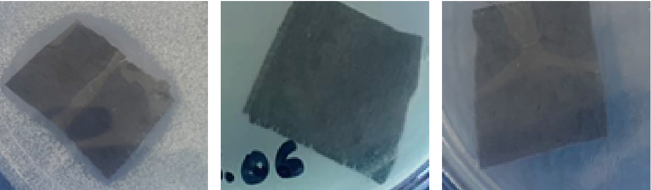
Рис. 3. Зовнішній вигляд зразків текстильних матеріалів та їх дія на: а) Candida albicans ATCC 10231; б) P. aeruginosa ATCC 9027; в) S. aureus ATCC 6538
