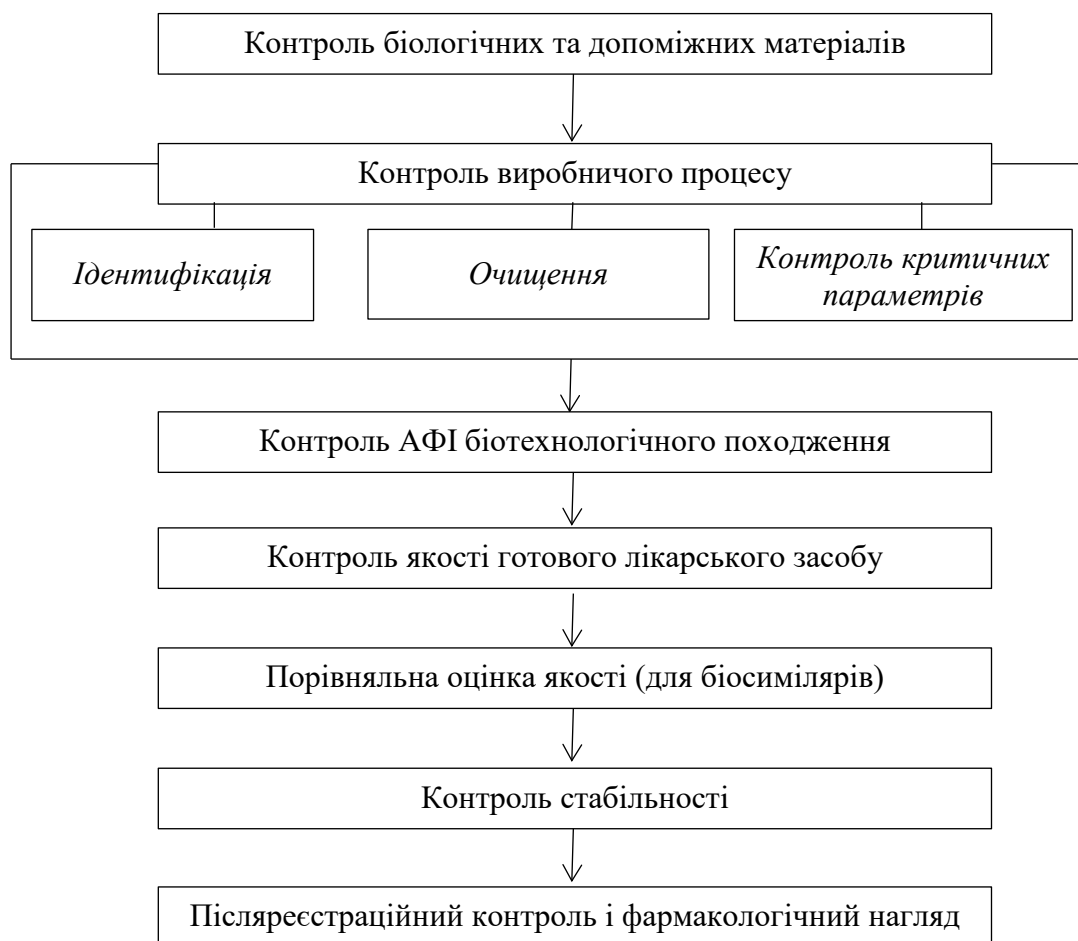
Рис. 3. Схема контролю якості біотехнологічного лікарського засобу
