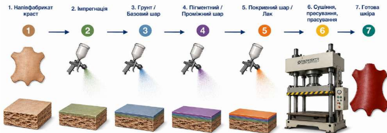
Рис. 1. Схема побудови оздоблювального покриття на поверхні шкіри
